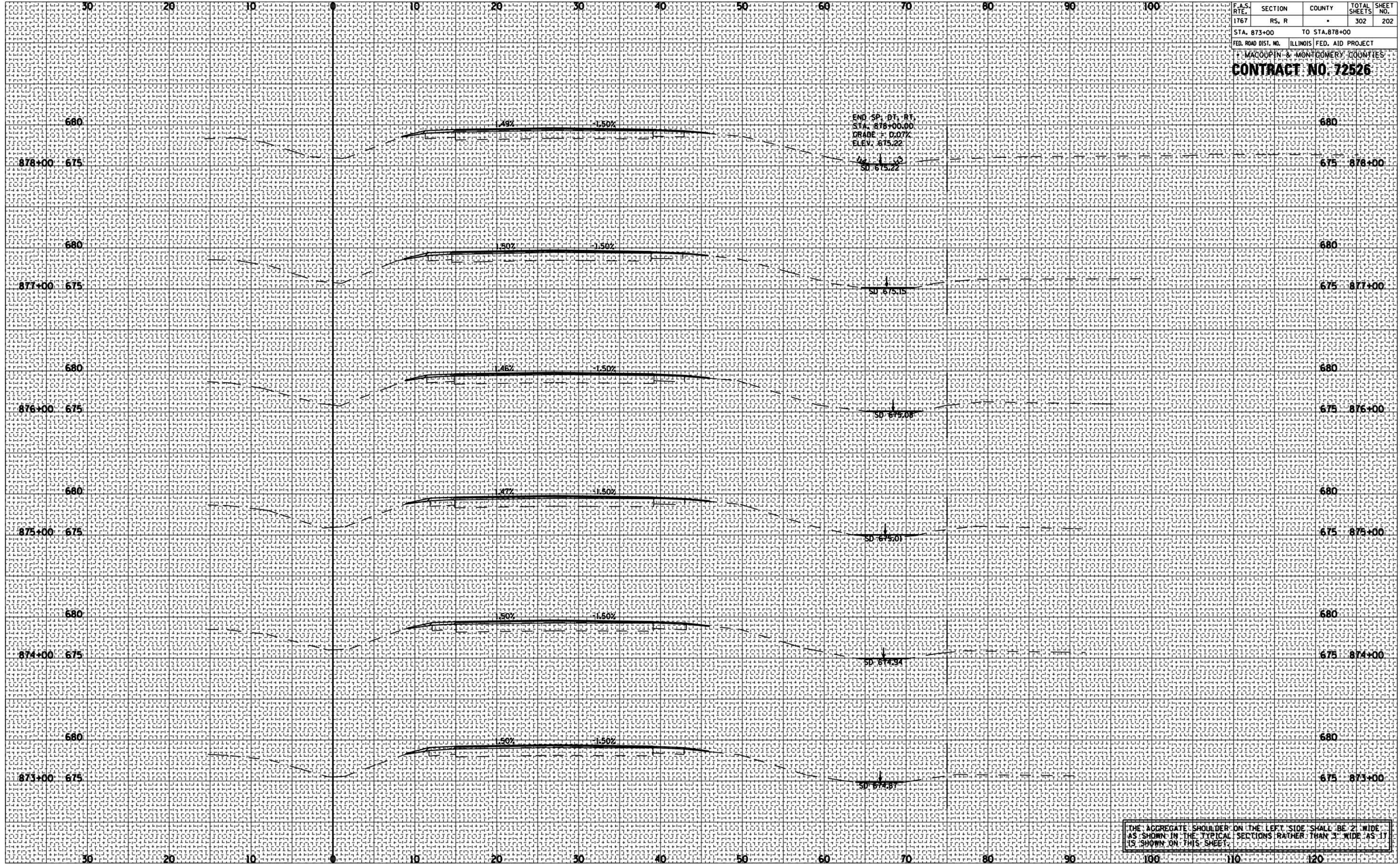
THE AGGREGATE SHOULDER ON THE LEFT SIDE SHALL BE 2' WIDE AS SHOWN IN THE TYPICAL SECTIONS RATHER THAN 3' WIDE AS IT IS SHOWN ON THIS SHEET.
