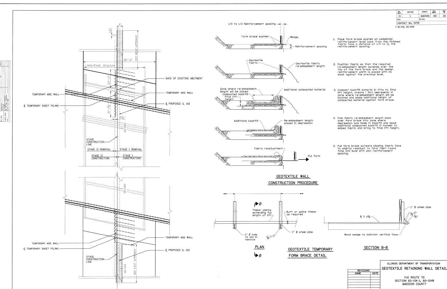
GEOTEXTILE RETAINING WALL DETAIL
