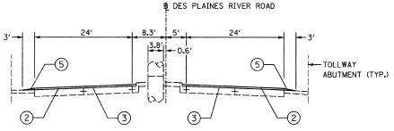
PROPOSED TYPICAL SECTION STA. 96+40 TO STA. 101+72
