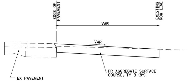
**SECTION A-A FOR EX EARTH/AGGREGATE CE**
