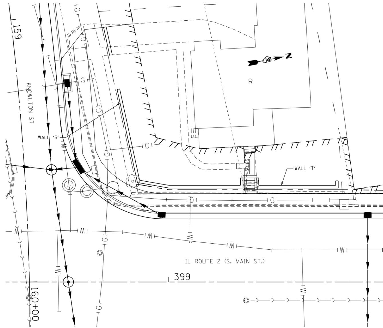
**SEGMENTAL CONCRETE BLOCK WALL PLAN**
