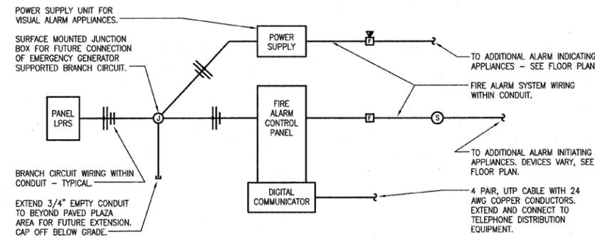
**E** FIRE ALARM SYSTEM SCHEMATIC
