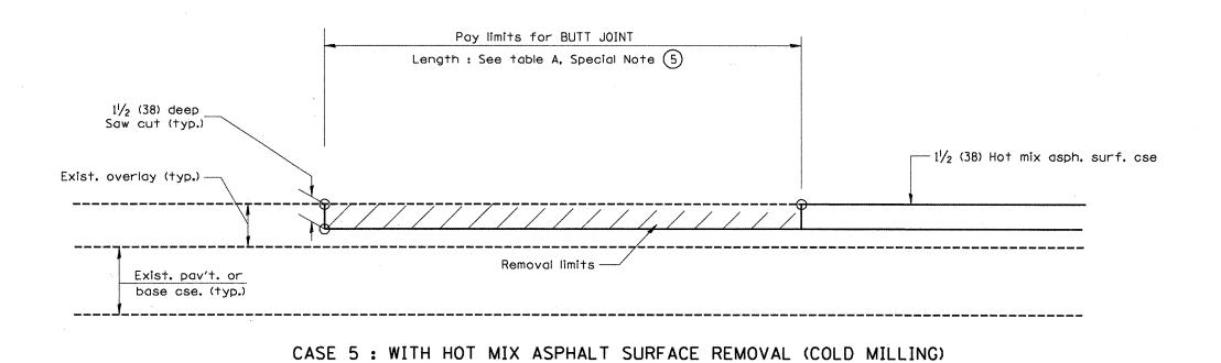
TIE-IN TO EXISTING BITUMINOUS TAPER
