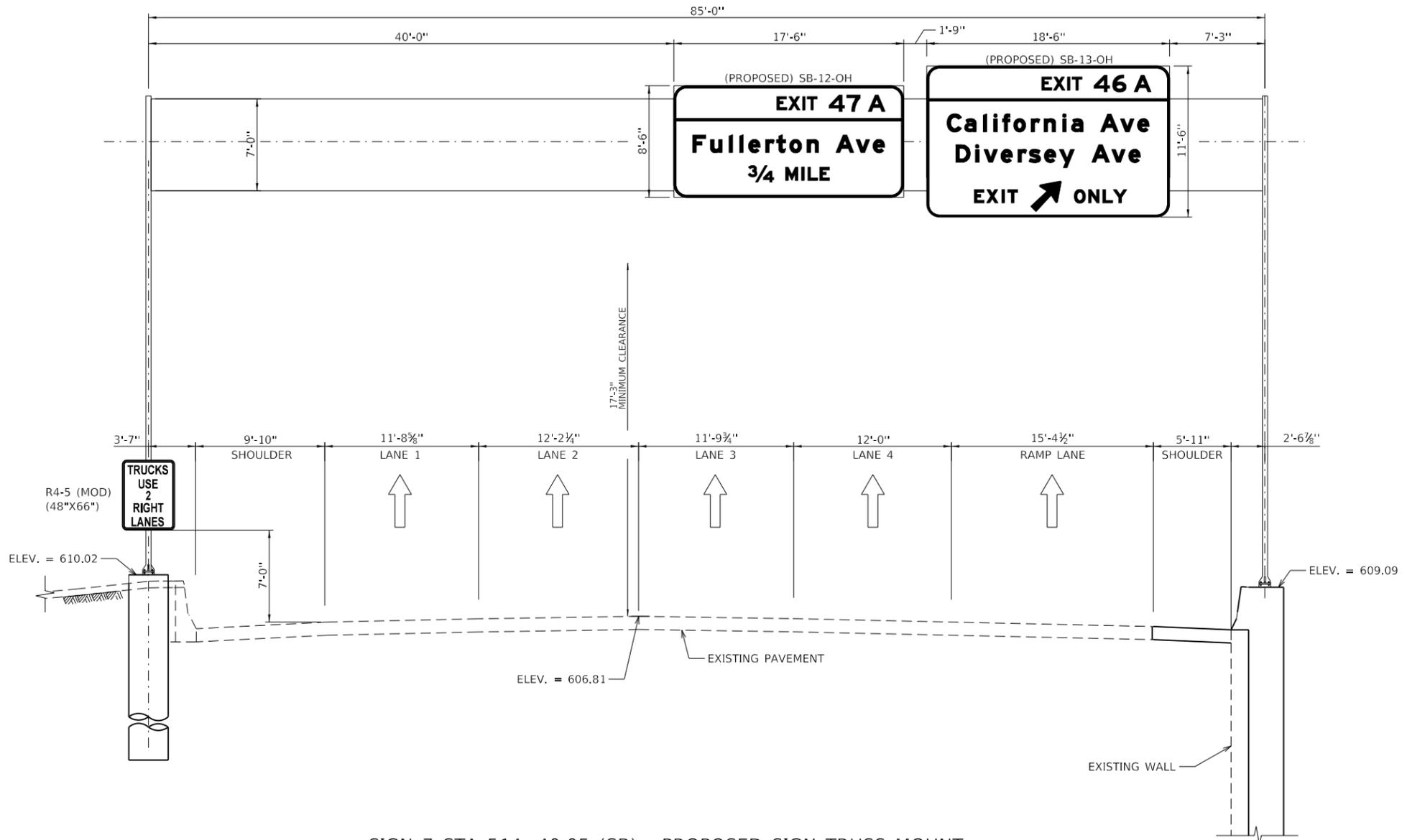
**SIGN 7 STA 514+40.05 (SB) - PROPOSED SIGN TRUSS MOUNT**
