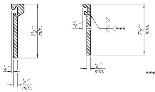
**ROULLED EXTRUDED RAIL**      **WELDED RAIL**
