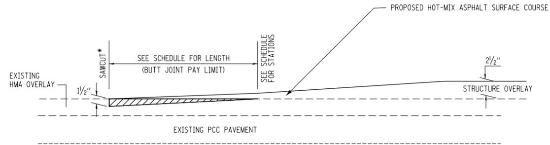
\*COST OF SAWCUT TO BE INCLUDED IN HOT-MIX ASPHALT SURFACE REMOVAL - BUTT JOINT ELEVATION VIEW
