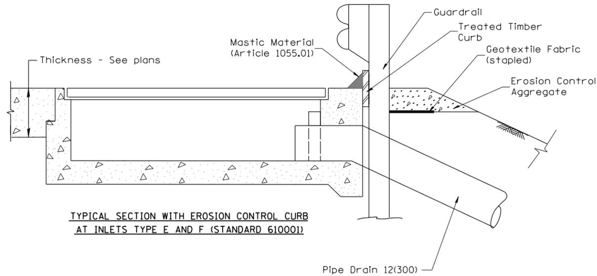
**TYPICAL SECTION WITH EROSION CONTROL CURB
