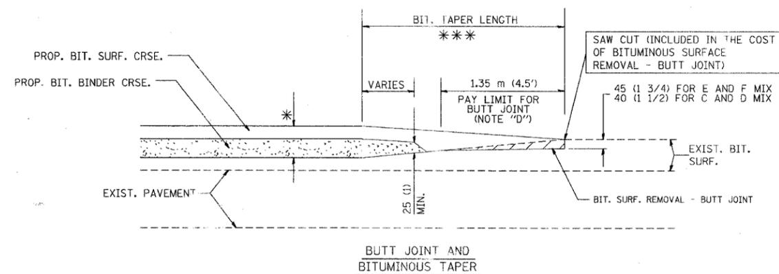
TYPICAL BUTT JOINT AND BITUMINOUS TAPER
