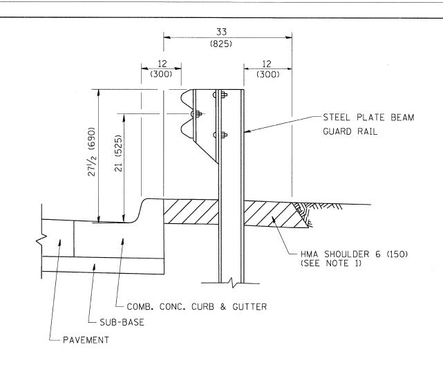
NOTES: 1. THE HMA SHOULDER SHALL EXTEND UNDER THE TRAFFIC BARRIER TERMINAL
